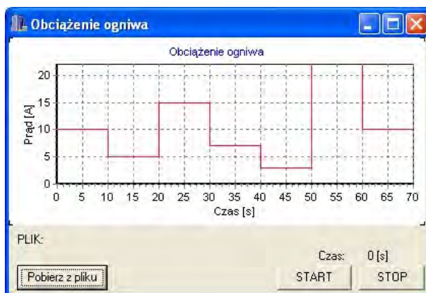
Rys. 9. Zakładka wprowadzania cyklu obciążenia z pliku
