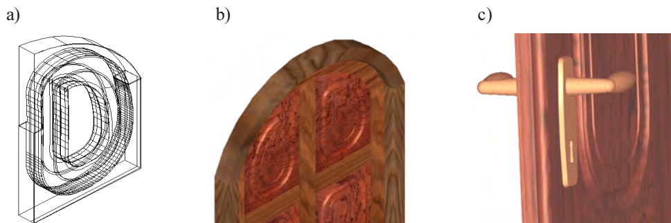
Rys. 7. Modelowanie filunku górnego a) model krawędziowy, b) po wstawieniu do ramiaka i po renderingu, c) fragment drzwi z klamką i szyldem
