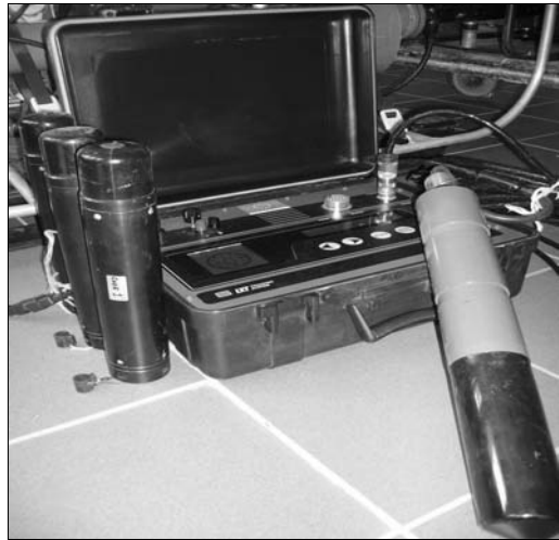
Fot. 4. System pozycjonowania pojazdu z super krótką bazą
