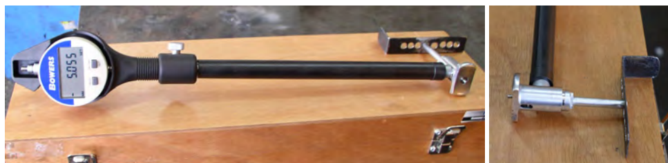
Rys. 8. Średnicówka elektroniczna wraz z szablonem użytym do pomiarów średnic cylindra
