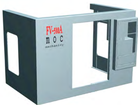
Rys. 2. Osłona pionowego centrum obróbkowego FV-580A zaprojektowana w module NX Sheet Metal
