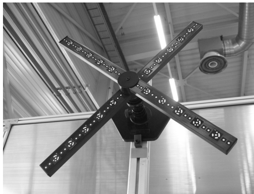
Rys. 3. Krzyż do kalibracji skanera optycznego
