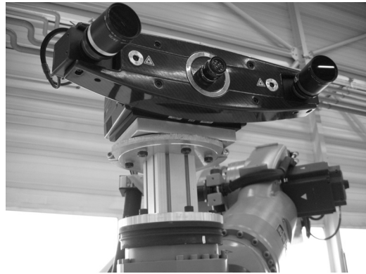
Rys. 2. Adapter mocujący skaner optyczny na ramieniu robota
