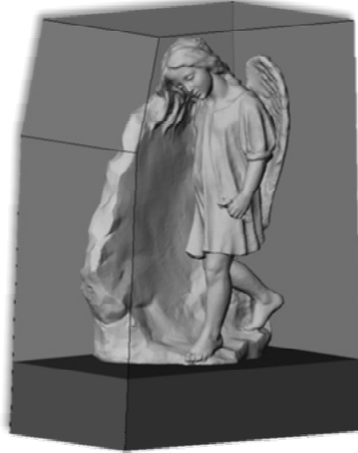
Rys. 3. Model CAD rzeźby wraz z wrysowaną przygotowką Fig. 3. CAD model of a sculpture with raw drawn into
