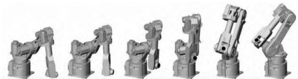
Rys. 4. Układy ramion robota w kilku wybranych chwilach czasowych podczas realizacji przejazdu między punktem 4 i 5
