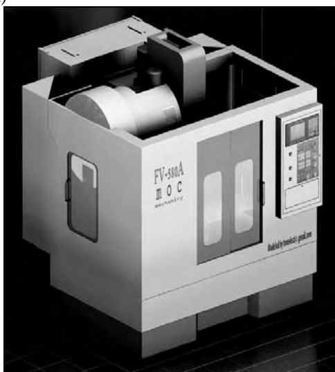
Rys. 6. Pionowe centrum obróbkowe FV580A: a) pełny model wirtualny, b) model obrabiarki bez osłon oraz magazynu narzędziowego
