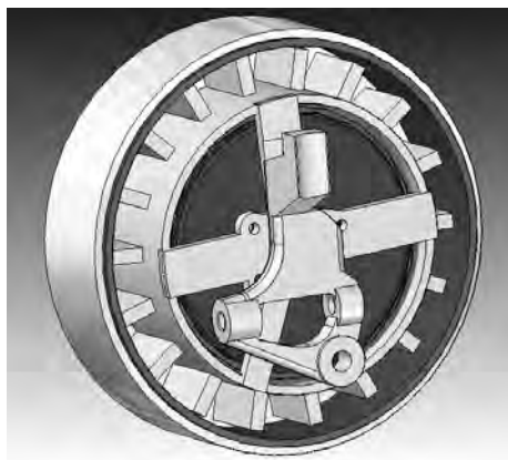
Rys. 6. Silnik na piaście z widocznym hamulcem i osłoną hamulca Fig. 6. Engine on the hub with visible brake and brake protection
