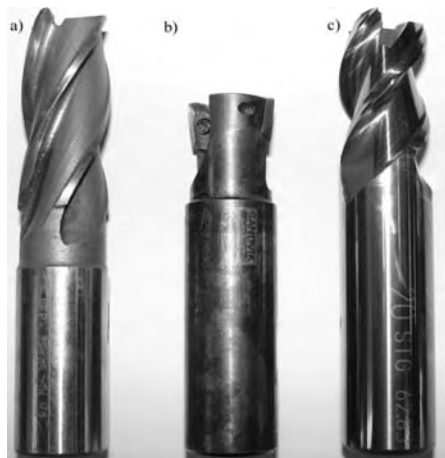
Rys. 1. Narzędzia zastosowane do obróbki: a) konwencjonalnej, b) HPC, c) HSM
