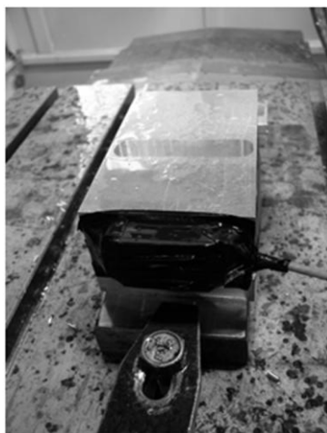
Rys. 5. Zamocowanie próbki na stole obrabiarki
